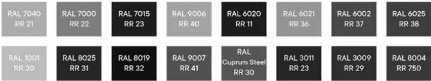
Рис. 2. Рекомендуемые колористические решения металлических элементов фасадов объекта (кровли, водосточков, ограждений, дверей)
