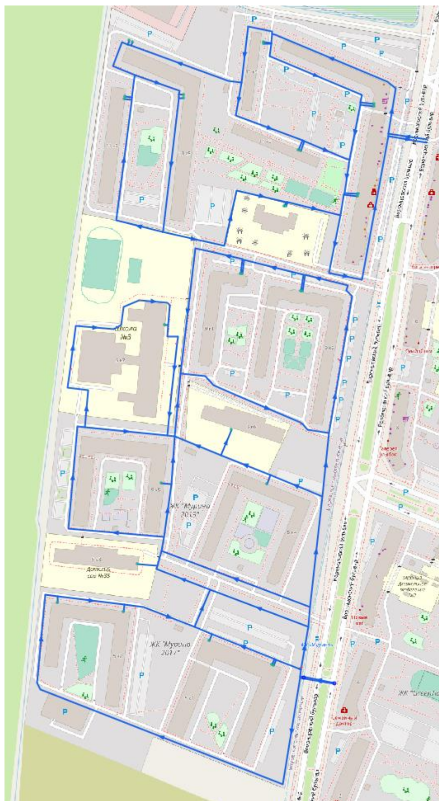
Рисунок 35 Схема водоснабжения п. Бугры (технологическая зона ВС №2)
