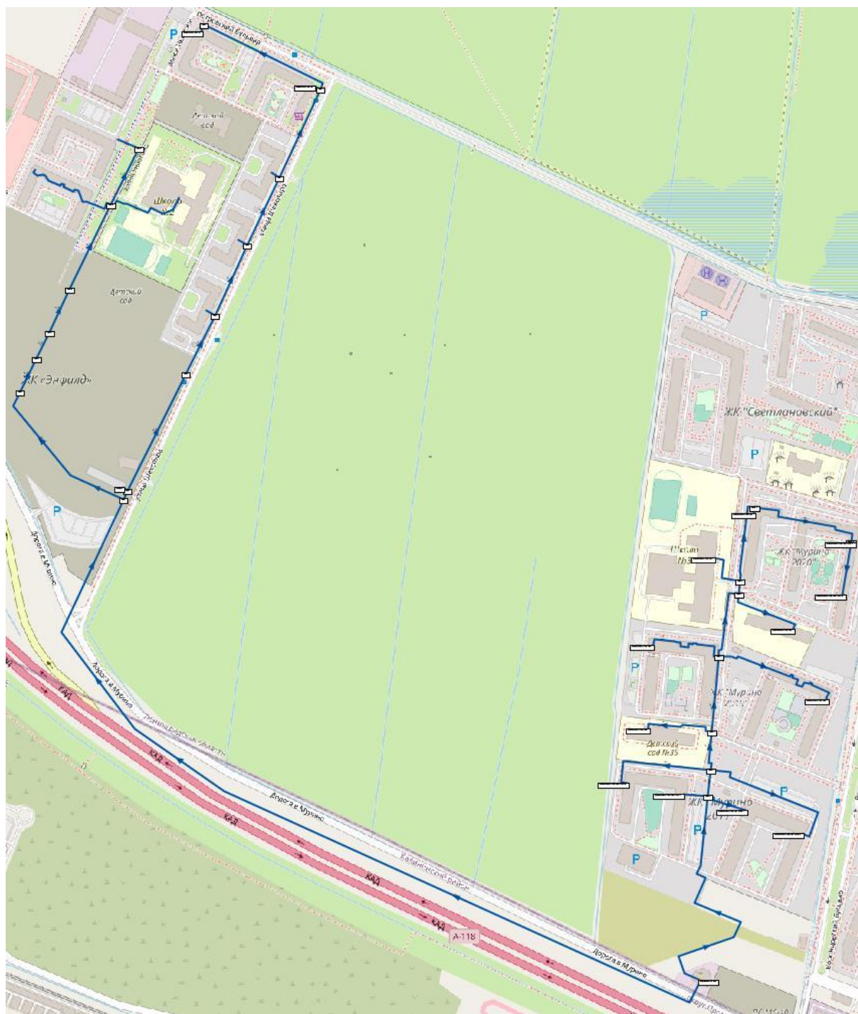
Рисунок 12. Схема тепловых сетей от котельной уч. 978 (зона действия №5), п. Бугры
