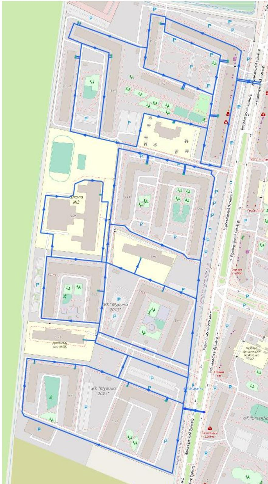
**Рисунок 27** Схема водоснабжения п. Бугры (технологическая зона ВС №2)
