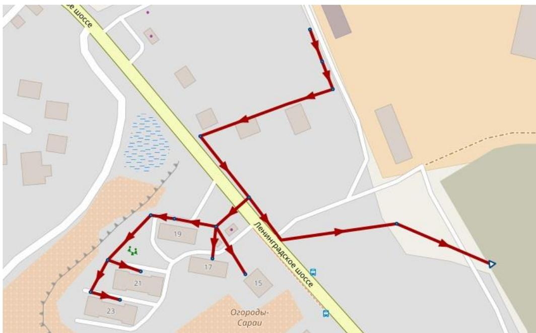
**Рисунок 39** Существующая схема водоотведения хозяйственно-бытовой канализации д. Порошкино (зона ВО №3)
